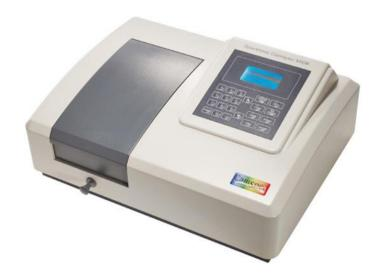
Das M108 ist die letzte Entwicklung der M100 VIS-Spektralphotometer – Modellreihe. Es ersetzt die Wellenlängen-Einstellung mit dem Drehknopf bei dem M107 Modell durch einen Prozessor kontrollierten Stepper-Motor und hat damit zusätzliche Eingabe-Möglichkeiten. Das M108 hat eine LCD-Anzeige mit 2 Linien 9 Ziffern und eine Tastatur mit 9 Drucktasten für eine einfache Bedienung, um damit Zugang zu den Möglichkeiten zu haben, die dieses intelligente Spektralphotometer bietet.
