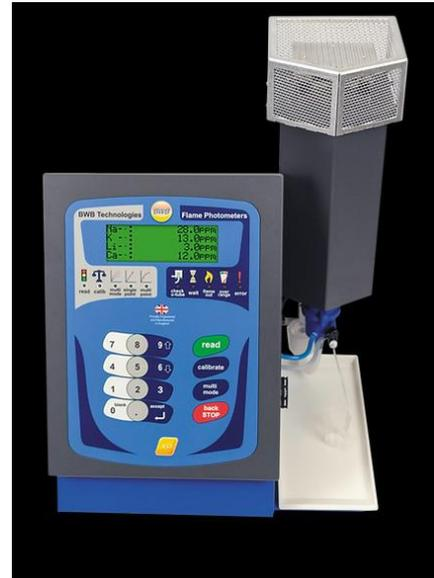
Überzeugen Sie sich von dem einzigartigen BWB Zucker-Flammenphotometer mit dem speziellen Kanaldetektor für Natrium und Kalium und seiner Mehrpunktkalibrierung. Auf Grund der Kundenanforderung wurde der entsprechende Auffangbehälter hergestellt, um kontinuierlich Online die Proben zu messen. Für die Online-Messung muß die Zuführung von mindestens 5ml Probe pro Minute für den Auffangbehälter gewährleistet sein.
